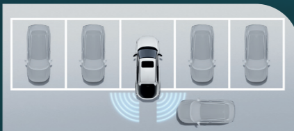
CROSS TRAFFIC MONITOR (CTM) ระบบเตือนเมื่อมีรถเคลื่อนผ่านขณะถอย
